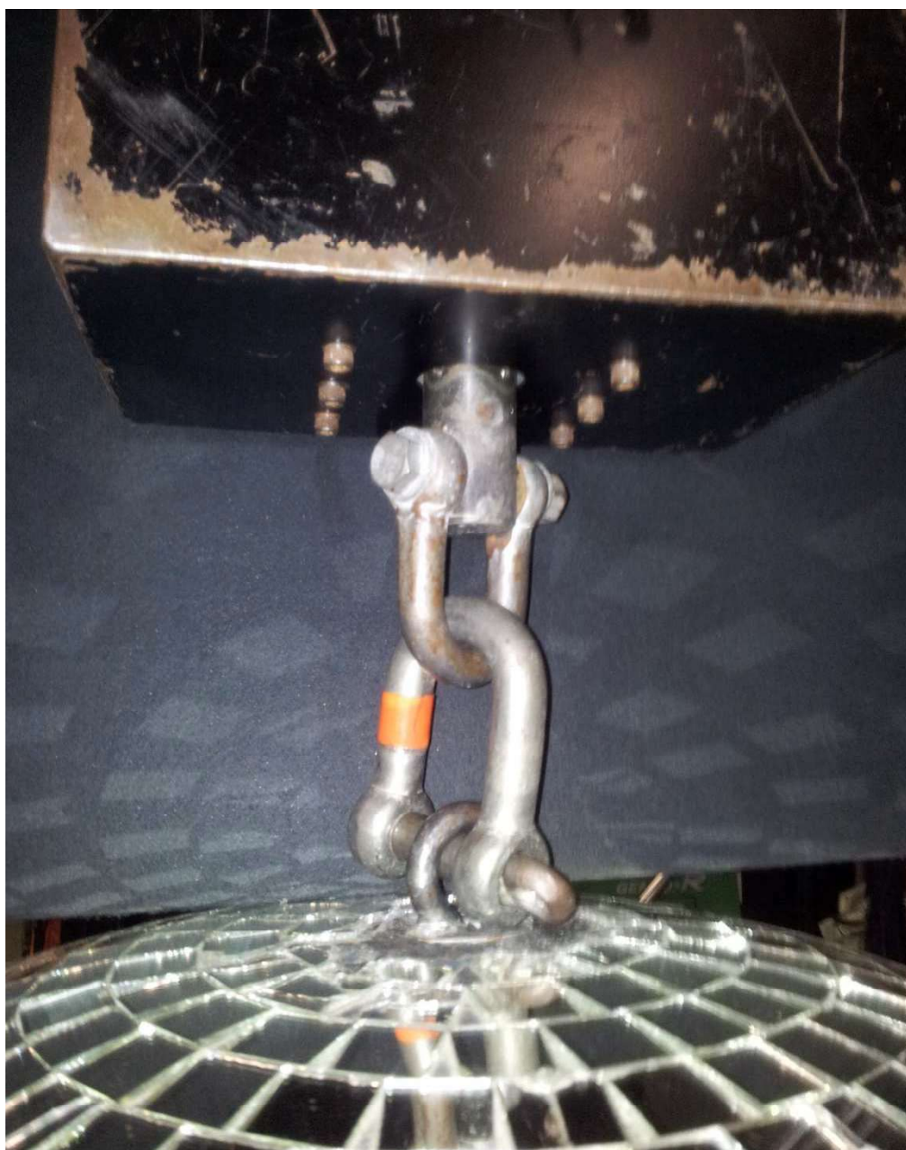
チェーンを使用せず直接モーターと接続する場合の画像です。
